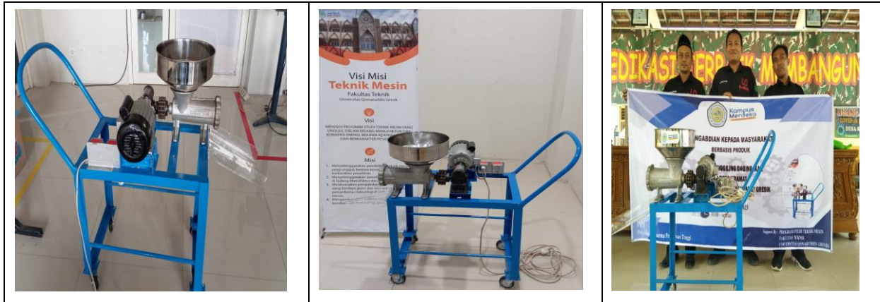
Gambar 4.3 Proses perakitan akhir dan bentuk mesin penggiling ikan
